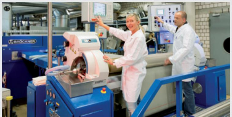
*Integration eines neuen Rotationssiebdruck-Moduls der Firma Stork in die Brückner Beschichtungsanlage*
