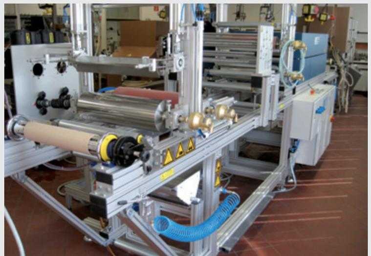
Neue Beschichtungs- und Kaschieranlage am ITCF
