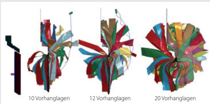
FEM-Aufprallsimulation textilbasierter Splitterschutzvorhangsysteme
