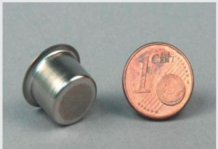
Lasergefertigte Spinddüse mit 2000 Mikrodurchbrüchen 25µm
