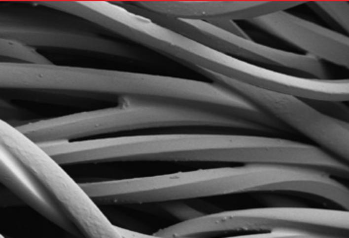
Mit einer anorganisch-organischen Dünnschicht homogen ummantelte Fasern mit UV-Schutzfunktion; ausgerüstet mit einem Sol aus 2% Siliciumalkoxid-Precursor und 1% Nano-Zinkoxid
