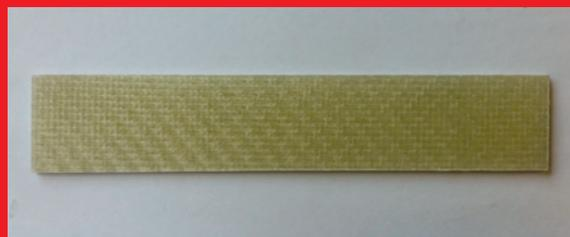
Glasfaser-Faserverbundwerkstoff mit Epoxidmatrix
