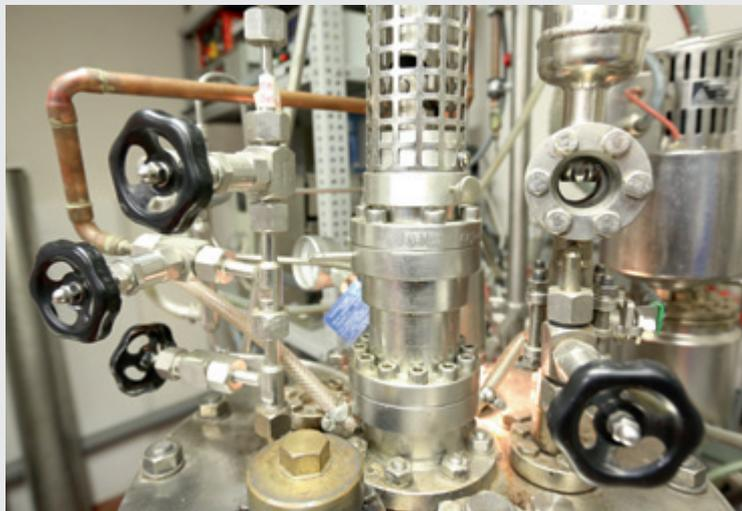
Reaktor zur Herstellung von Polyamiden
