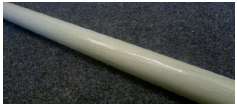
Vierlagiges, pultrudiertes Flechtrohr mit thermoplastischer Matrix
