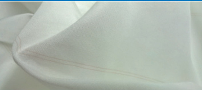
Gewebe mit feuchtesensorischen Garnstrukturen
