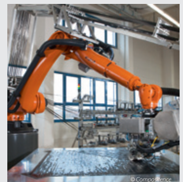
Tapelegeanlage der Fa. Compositence. Eine vergleichbare Anlage steht am ITV
