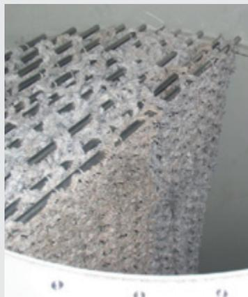
Textile Trägermaterialien im anaeroben thermophilen Pilotreaktor
