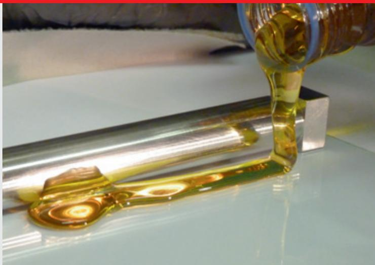
Auftrag einer ionischen Flüssigkeit auf eine Trägerplatte beim Folienziehversuch
