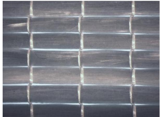
**Abbildung 1: EasyLeno® 2T Drehergewebe mit 1.200 tex Glasroving im Schuss**
