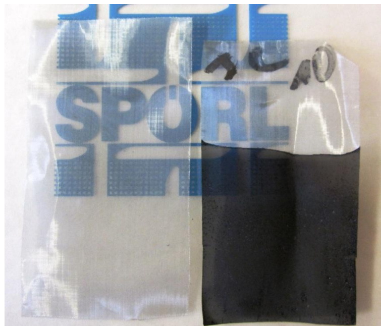
Abbildung 12: Metallgewebe (Spörl SD-PLUS 56/16) vor (links) und nach der elektrochemischen Abscheidung von PPy/IC (rechts).
