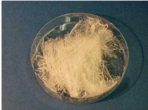
Abbildung 1: Grünfasern aus einem Calciumphosphat-Prekursor, hergestellt über ein Rotations-Jet-Spinnverfahren
