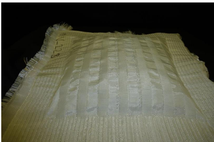
Bild 5: Sphärisch gekrümmtes Abstandsgewebe
