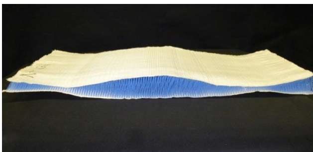
Bild 1: Abstandsstruktur mit bogenförmiger Krümmung in Kettrichtung und das dazugehörige Steuerprofil der Pollängenänderung über die Kettlänge
