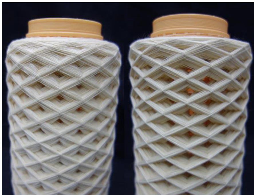
Abbildung 2: Sequenzspulen, mit (links) und ohne (rechts) Abstand zur Stützwalze gespult
