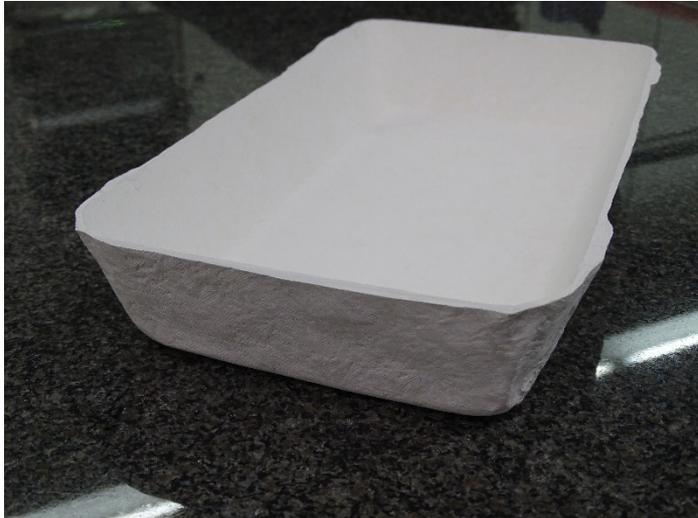
Abbildung 1: Sinterschale gefertigt aus kurzfaserverstärkten OFC.
