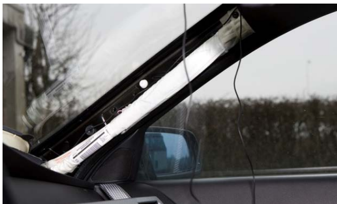
Abb. 1: Mit Airbag ausgestattete A-Säule. Zusammen mit der Verkleidung müssen die Geometrien so gewählt werden, dass das Sichtfeld des Fahrers weitgehend frei bleibt. Eine engere Faltung ist hier nicht möglich 3 .
