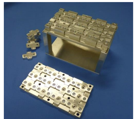
Abbildung 2: Gussform zum flexiblen Vergießen von bis zu 12 verschiedenen Bauteilen
