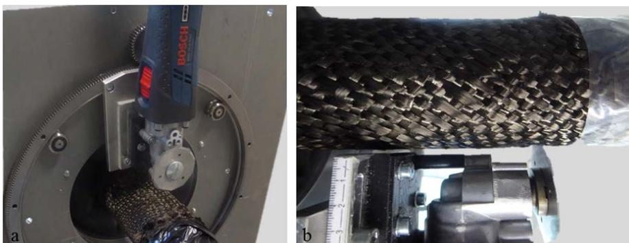
Abb. 4: Gesamtaufnahme (a) und Detailaufnahme (b) des Schneidesystems
