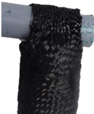
Abbildung 6: Schlaufenverbindung, hergestellt auf der Radialflechtmaschine
