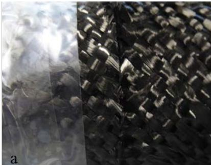
Abb. 5: Schnitt durch zweilagiges Kohlenstofffasergeflecht
