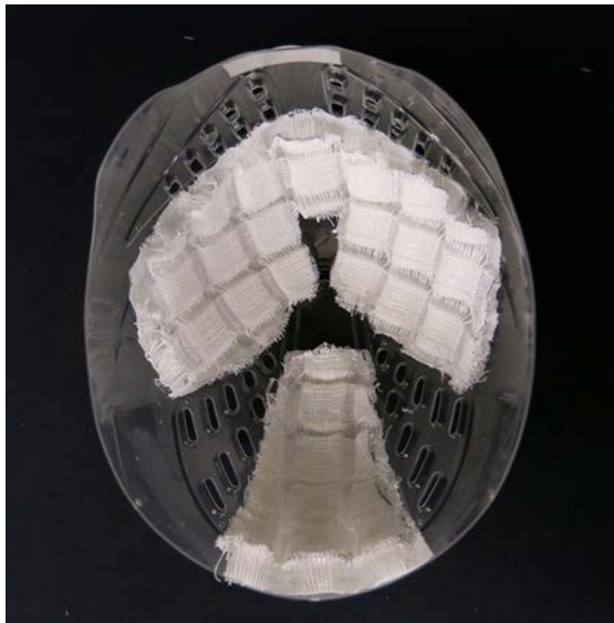
Abbildung 3: In die Helmschale eingelegtes Abstandsgewebe mit Füllöffnungen
