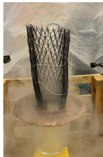
Abbildung 1: Feuchteabscheidernetz in Halbrundform
