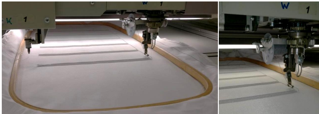
Abbildung 4: Stickvorgang zum Aufbringen der Kontaktierung
