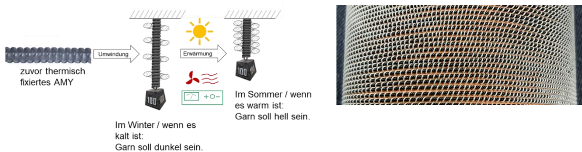
Abbildung 2: Prinzipskizze für ein Gap-Reflect-Garn mit AMYs und eine umgesetzte Variante
