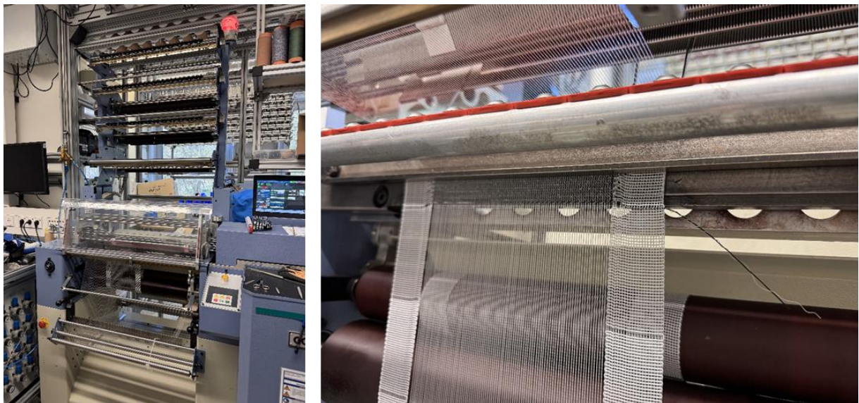
Abbildung 3: Integration von AMYs und Gap-Reflect-Garnen in Wirkware als Schussfaden
