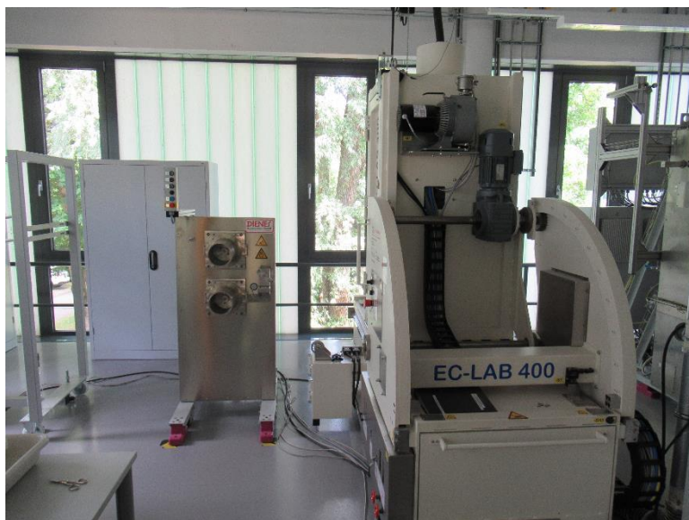
Abbildung 1: Die Elektronenbestrahlungsanlage am HPFC
