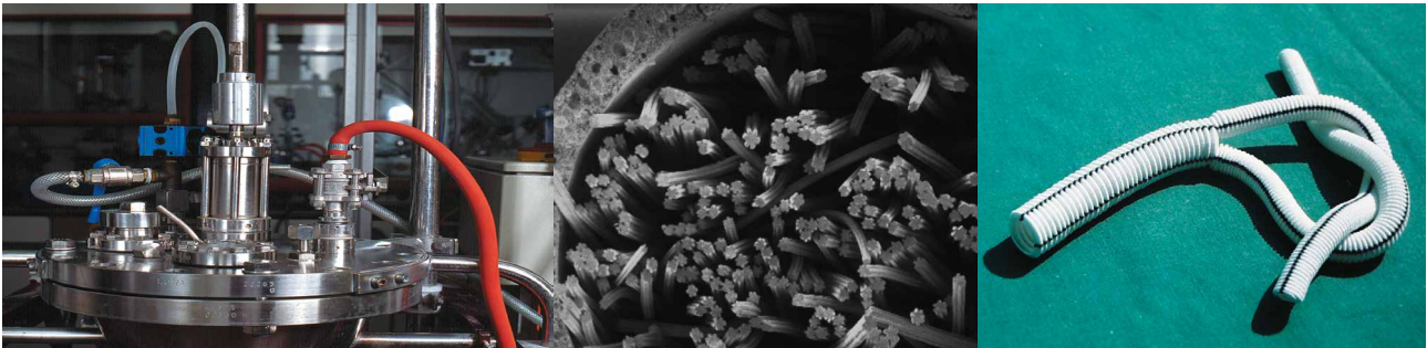
Links: Polymerlabor: Reaktor zur Polymerisation von resorbierbaren Polymeren.
