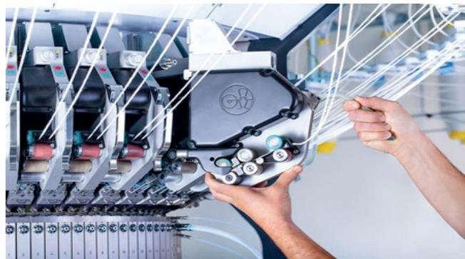
Abbildung 3: Streckwerk an Spinit®-Maschine Mayer & Cie<sup>4</sup>
