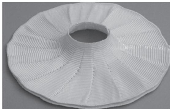
Abbildung 4: 3D-gestrickter Rotordeckel<sup>5</sup>
