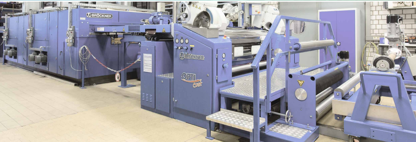
Beschichtungslinie, modular aufgebaut mit 1,60 m Warenbreite.
