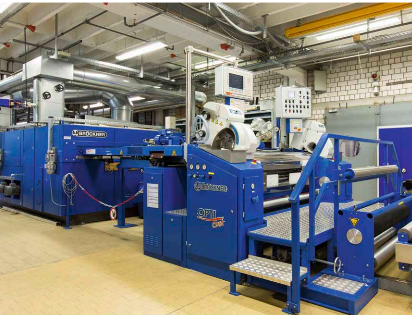
Modulare Beschichtungslinie zur Beschichtung und Laminierung bis 1,60 m Warenbreite.
