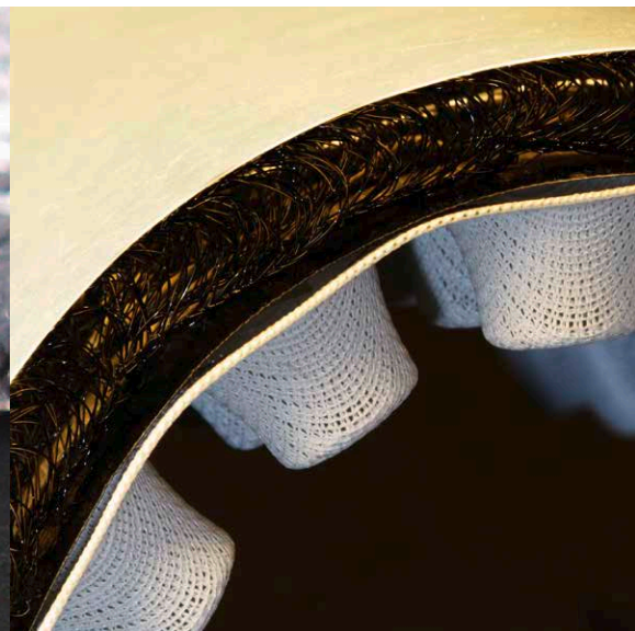
Textile Solarthermie mit Noppenstruktur.
