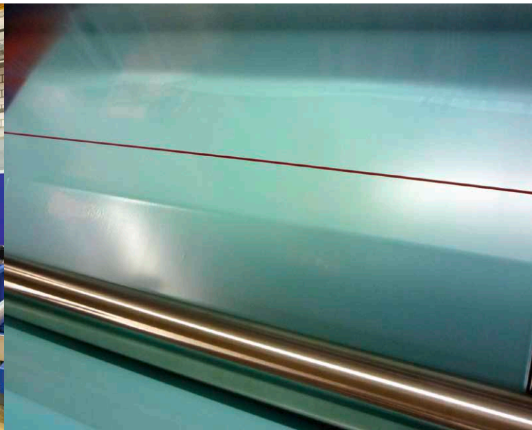
Kaschierung einer wasserdampfdurchlässigen Membran auf einem Gestrick.
