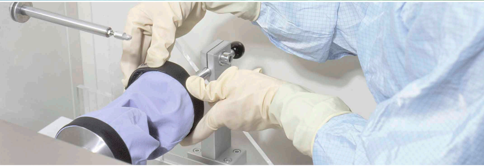
Messung von Partikelemission unter Reinraum-Bedingungen.
