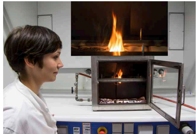
Brandprüfung eines Gewebes.
